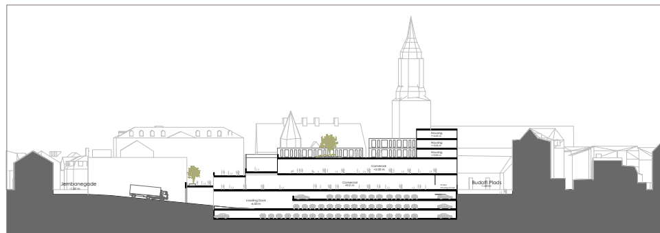
Principsnittet illustrerer indretning af nyt underjordisk p-anlæg. Illustration: Henning Larsen Architects.
