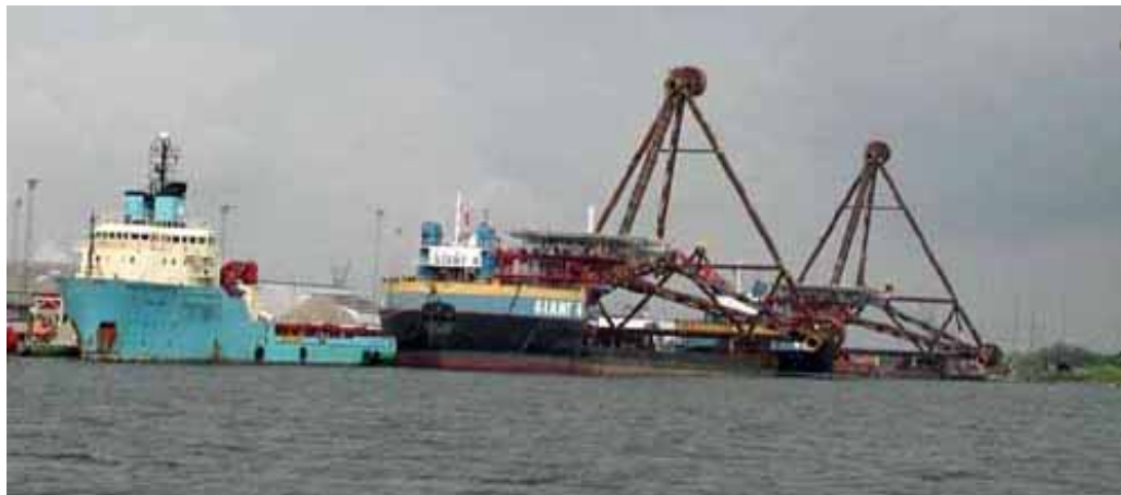
Lastning af offshorekonstruktioner til havs.
